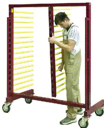
Changement de place du râtelier selon l'exemple du chariot à étagères R660-1/1
